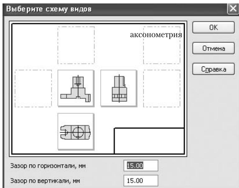
Указав точку привязки, получаем виды, расположенные в проекционной связи. Это **ассоциативный чертеж** модели. Все изменения, выполненные в модели, будут отображаться на чертеже.
