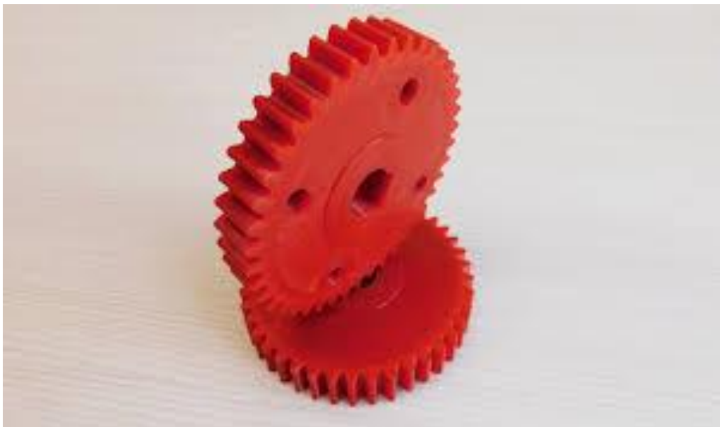
Рис. 3 – шестерня, яка надрукована на 3D-принтері.
