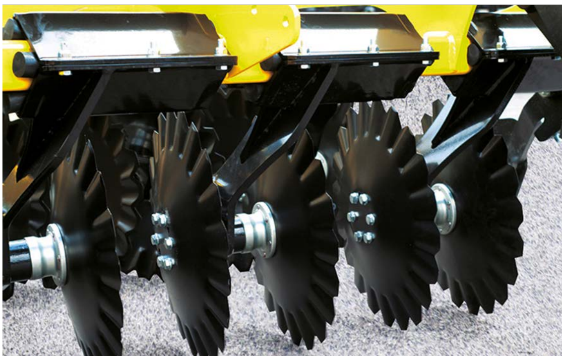
Рис. 1. Гофрований дисковий робочий орган конічної форми знаряддя «Disc Cultivator SWIFTERDISC XN» фірми BEDNAR FMT s.r.o. [4, с.9]
