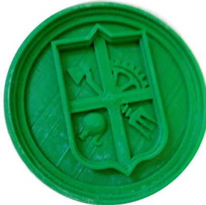
Рис. 7. Майстер-модель з матеріалу PLA для виготовлення гербів з гіпсу чи інших матеріалів
